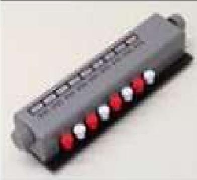
Manual, Con la estructura moldeada externa en plástico y co resistente ABS interna mecanismo y base de metal, contador de células sanguíneas manual de 8 tiene botones y perillas en ambos extremos para restablecer el recuento.
