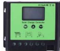
Controlador de carga fotovoltaica (PV) que rastrea la matriz fotovoltaica para entregar la corriente disponible para cargar las baterías. Al cargar, el controlador regula el voltaje de la batería y la corriente de salida en función de la cantidad de energía disponible de la matriz FV y del estado de carga de la batería. El controlador se puede utilizar con 12, 24, 48 sistemas de batería CC, máx. Entrada PV 100VDC.
